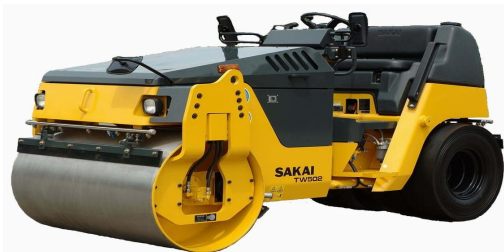
Рисунок 1.13 - Комбинированный каток SAKAI TW 502 включающий в себя передний гладковальцовыйвибровалец и задние гладкие пневмошины
