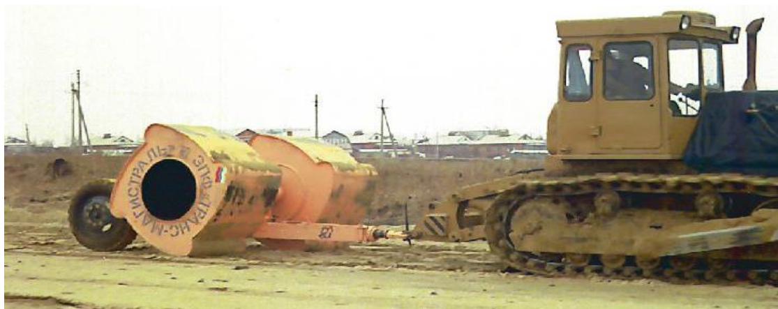
Рисунок 1.10 - Прицепной ударный каток ДМ-7 с некруглыми вальцами
