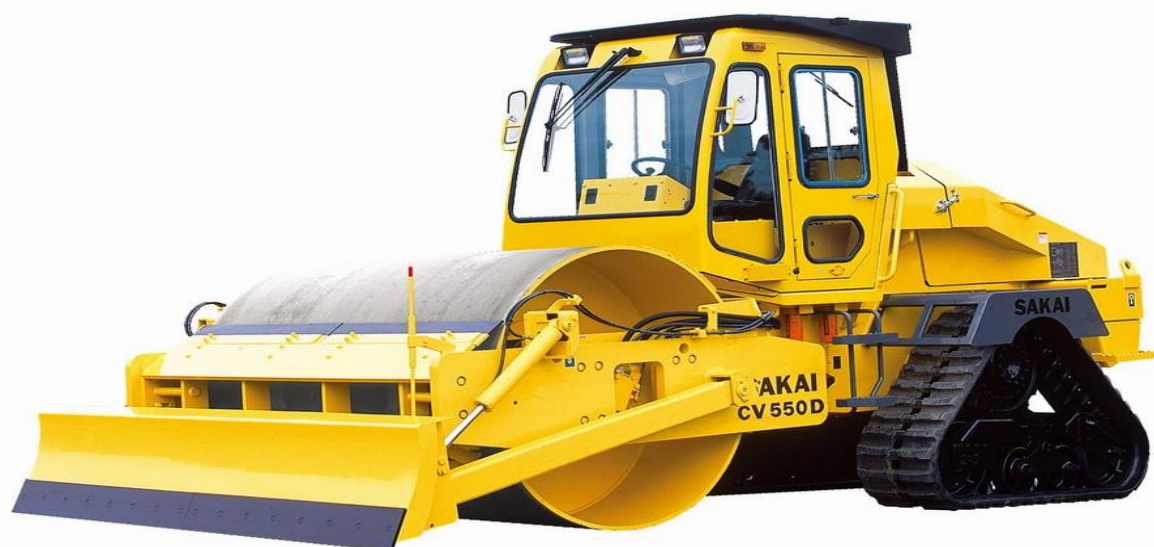
Рисунок 1.14 - Самоходный вибрационный каток SAKAI CV550D для уплотнения откосов и других строительных площадок, расположенных под уклоном к горизонту
