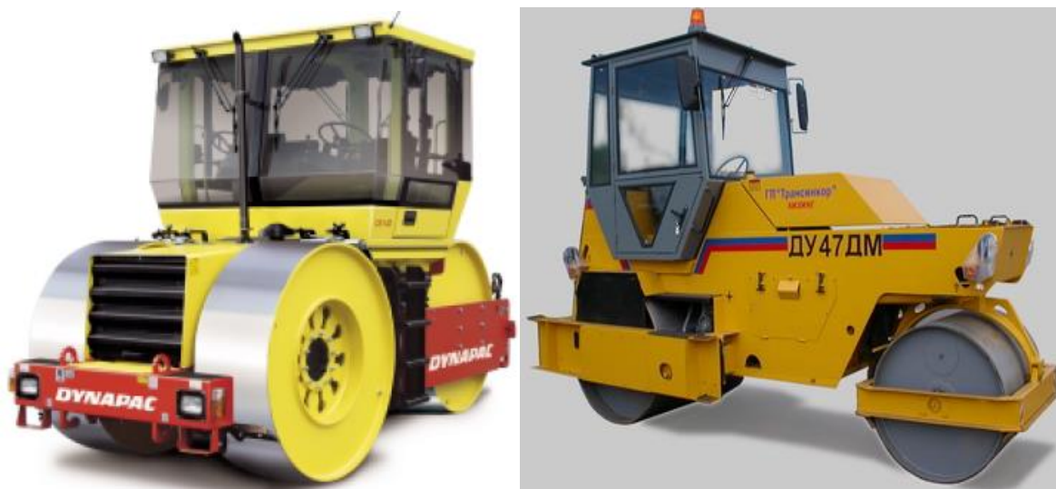
Рисунок 1.1 - Статический гладковальцовый каток фирмы Дунарас и каток ДУ47ДМ фирмы «Раскат»
