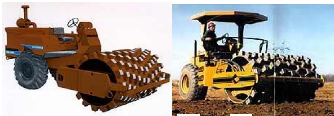
Рисунок 1.7 - Самоходный каток с кулачковым вибровальцем фирмы "Dresser" (а) и кулачковый каток фирмы «Ingersoll-Rand» (б), (США)
