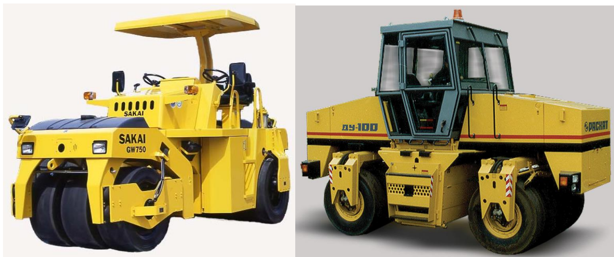
Рисунок 1.2 - Единственный в мире пневмошинный вибрационный каток GW750 фирмы «Sakai» и каток ДУ-100 фирмы «Раскат»
